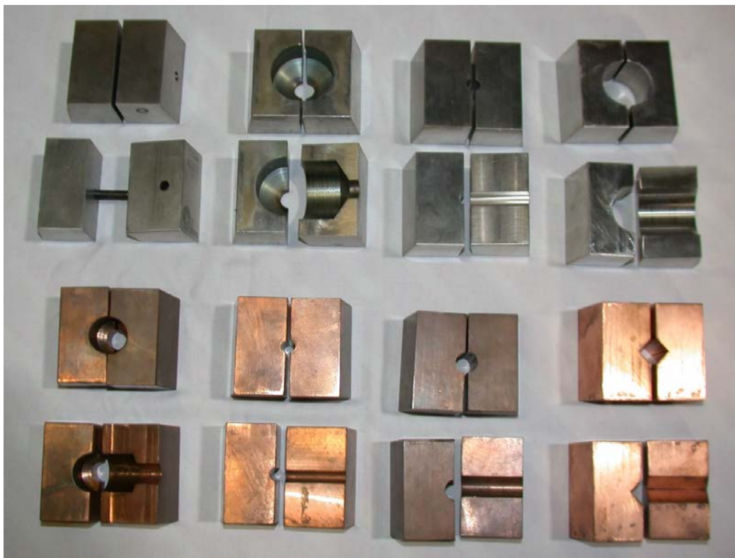
Obrázek 3.5: Čelisti s úplným i částečným kontaktem z mědi a oceli pro různé tvary vzorků [9]
