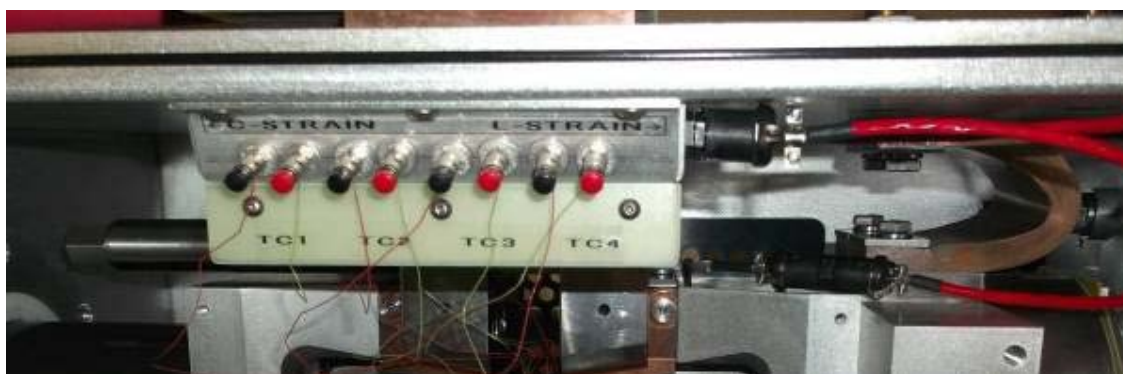
Obrázek 3.3: Zapojení termočlánků ve čtyřech možných kanálech [9]
