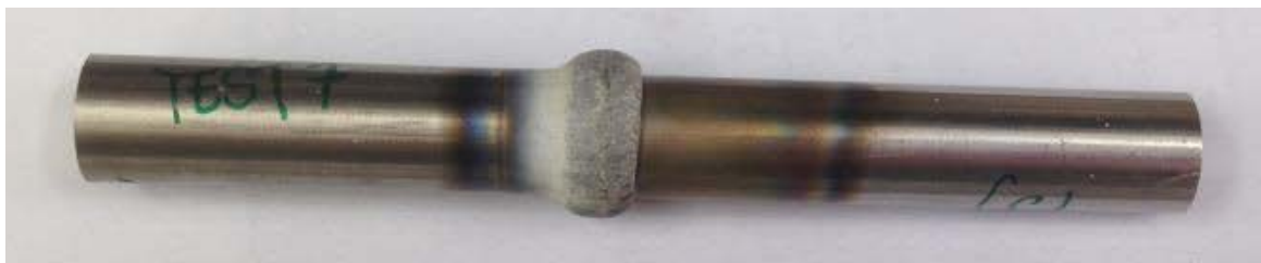
Obrázek 5.2: Větší deformace titanové části vzorku (vlevo) a její přesun přes hranu oceli
