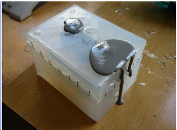
Obr. 4.23 Odlievanie s použitím plniva.
