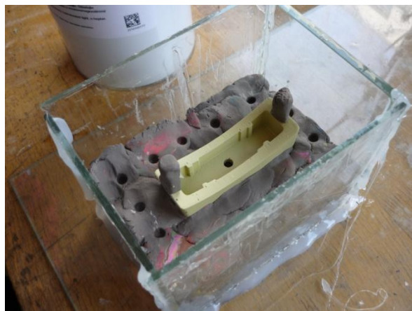
Obr. 4.6 Umiestnenie modelu v sklenenej nádobe.
