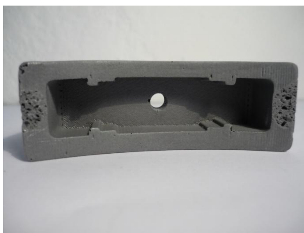
Obr. 4.26 Finálny model po teste s trhlkou.
