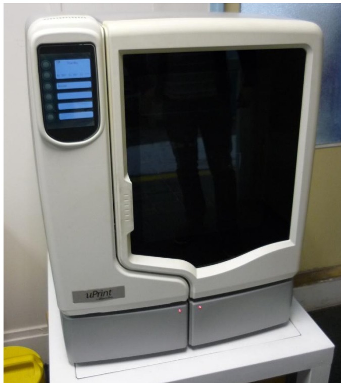
Obr. 3.8 3D tlačiareň Dimension uPrint.
