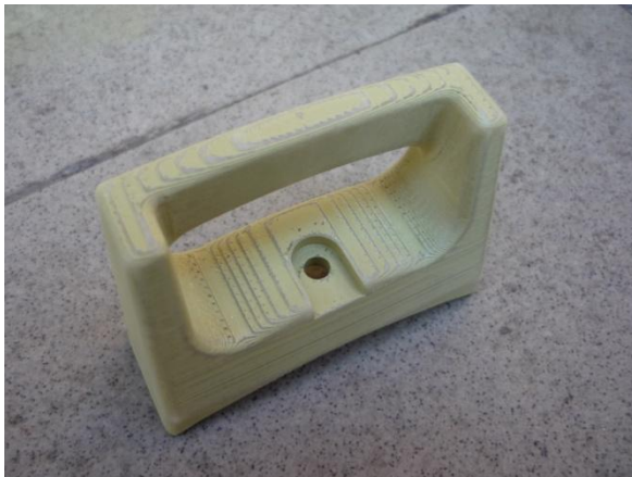
Obr. 4.3 Vyhladenie pomocou brúsneho papiera.
