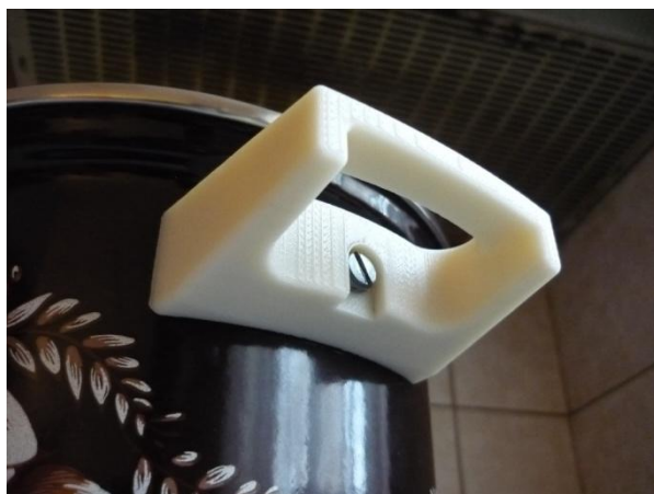
Obr. 3.10 Upevnenie modelu ucha na hrnci.
