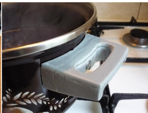
Obr. 4.25 Vôľa medzi modelom a hrncom.
