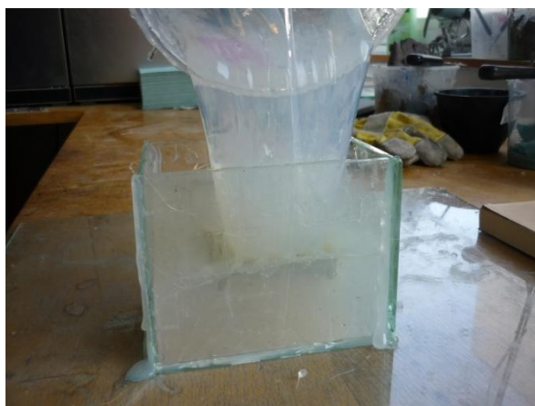
Obr. 4.12 Odlievanie tretieho dielu formy.
