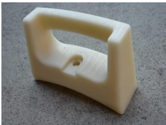
Obr. 4.1 Nerovnosti na povrchu modelu.
