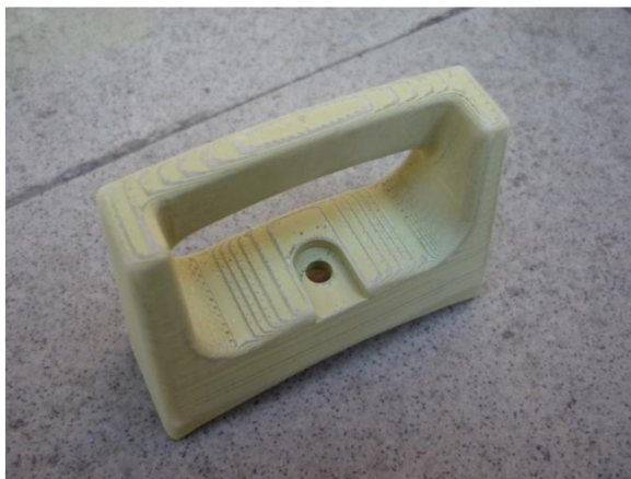
Obr. 4.3 Vyhladenie pomocou brúsneho papiera.
