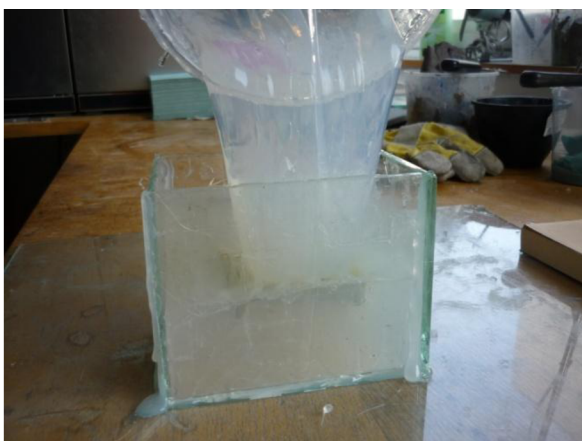
Obr. 4.12 Odlievanie tretieho dielu formy.
