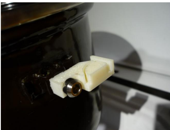
Obr. 1.2. Upevnenie testovacieho plastu.
