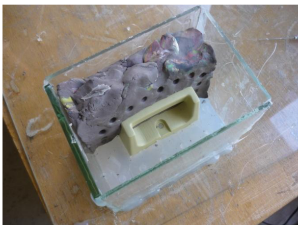
Obr. 4.11 Výroba druhého dielu formy.
