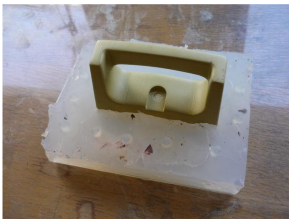
Obr. 4.10 Prvý diel silikónovej formy.
