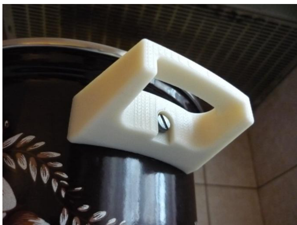
Obr. 3.10 Upevnenie modelu ucha na hrnci.
