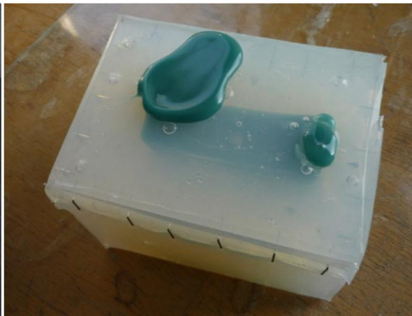
Obr. 4.14 Odlievanie voskového modelu.
