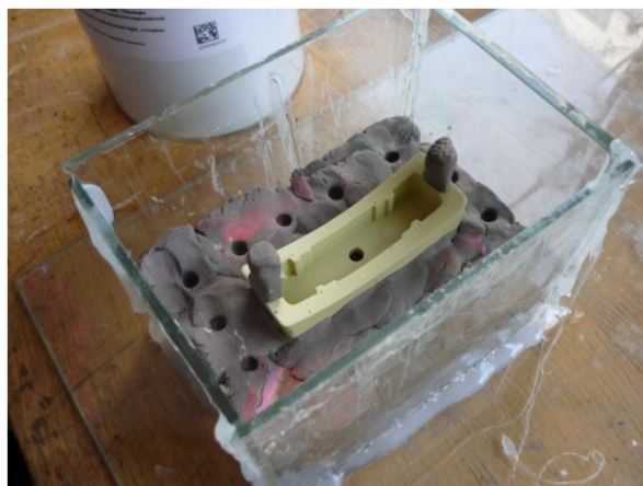
Obr. 4.6 Umiestnenie modelu v sklenenej nádobe.
