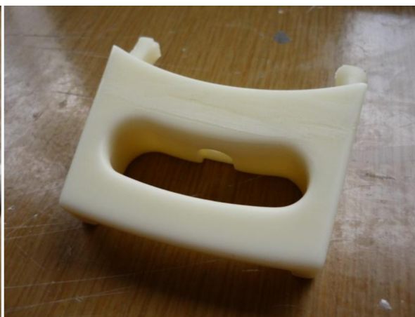
Obr. 4.18 Model odliaty z plastu AXSON F18 so vtokovými sústavami.
