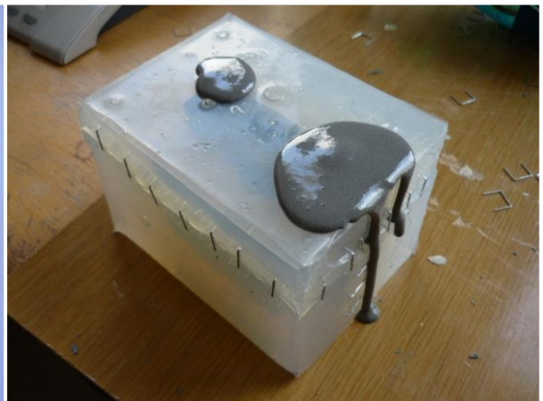
Obr. 4.23 Odlievanie s použitím plniva.
