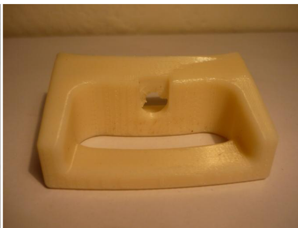
Obr. 3.11 Poškodenie prvého modelu.
