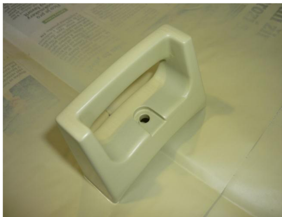
Obr. 4.4 Úplné vyhladenie modelu.
