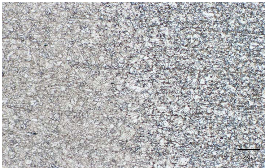
Obr. 42 Přechod do pásma vyšších teplot – pásmo normalizace. Leptáno Nitalem 1%.
