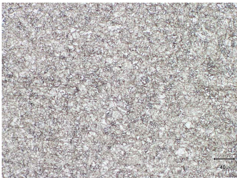
Obr. 41 Tepelně neovlivněný základní materiál. Jemná feriticko perlitická struktura. Leptáno Nitalem 1%.
