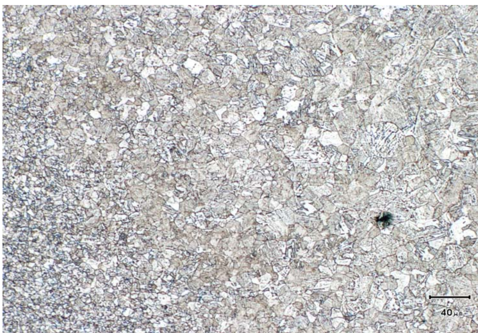
Obr. 43 Přechod do pásma přehřátí se vyznačuje hrubnutím zrna. Leptáno Nitalem 1%.
