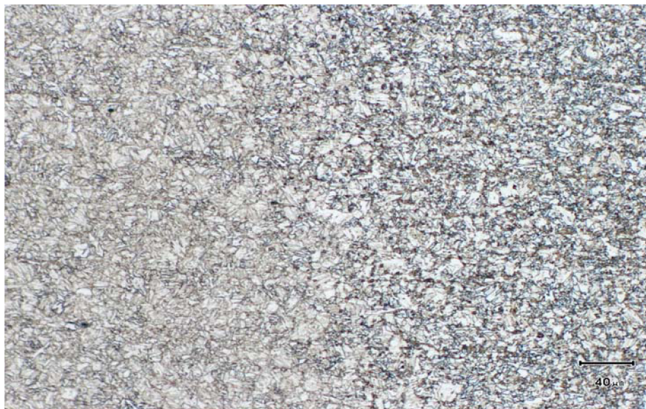
Obr. 42 Přechod do pásma vyšších teplot – pásmo normalizace. Leptáno Nitalém 1%.
