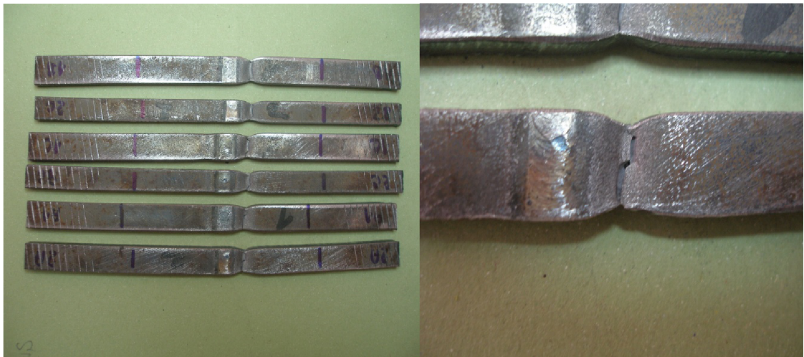
Obr. 38. Vzorky po zkoušce tahem.
