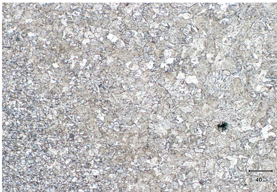
Obr. 43 Přechod do pásma přehřátí se vyznačuje hrubnutím zrna. Leptáno Nitalém 1%.
