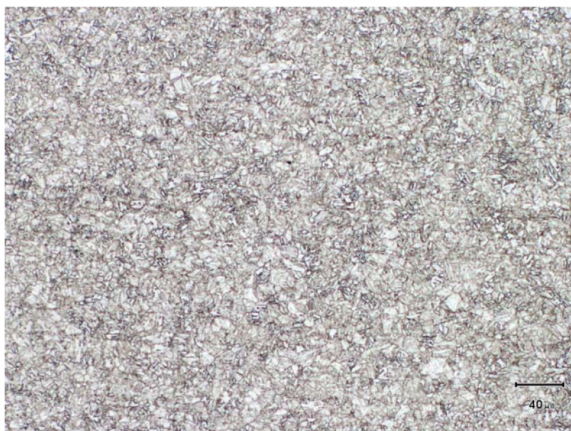
Obr. 41 Tepelně neovlivněný základní materiál. Jemná feriticko perlitická struktura. Leptáno Nitalém 1%.
