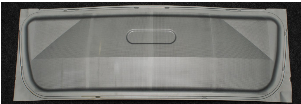
Obr. č. 5.1 Výlisek po operaci hlubokého tažení s deformační sítí na povrchu
