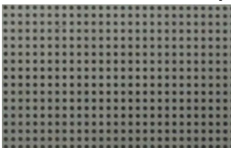
Obr. č. 2.5 Příklad deformační sítě na plechu se zinkovým povlakem
