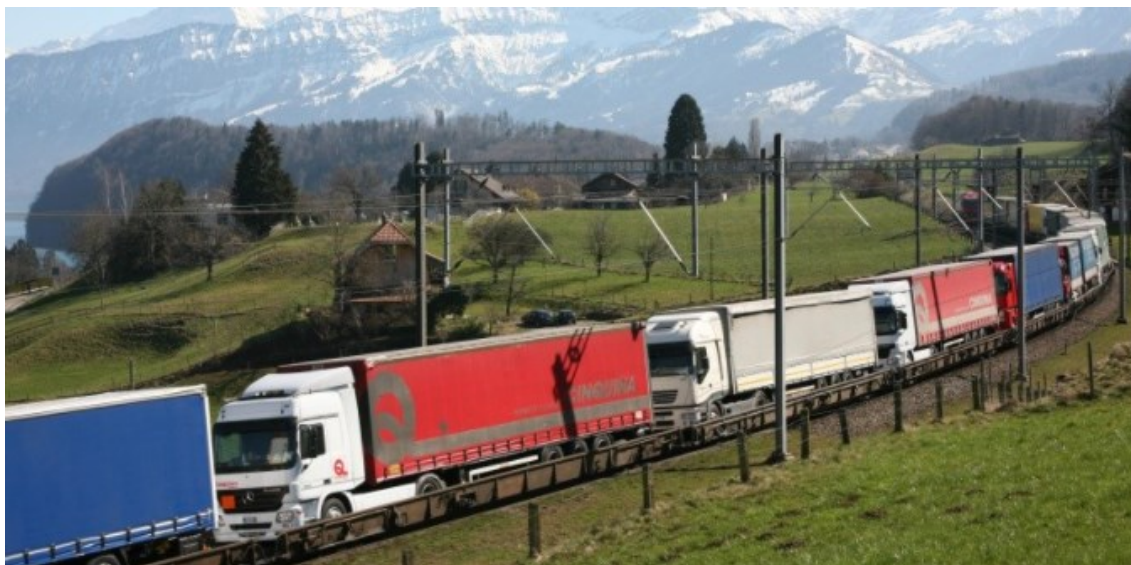
Obr. 4.24 Tunelová průvozní doprovázená přeprava (RoLa)
