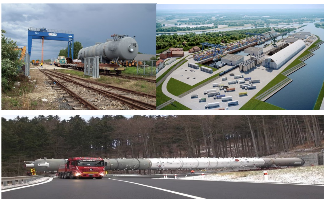
Obr. 5.7 Komplikovaná přeprava nadrozměrného nákladu horským průsmykem a možnost jejího řešení
