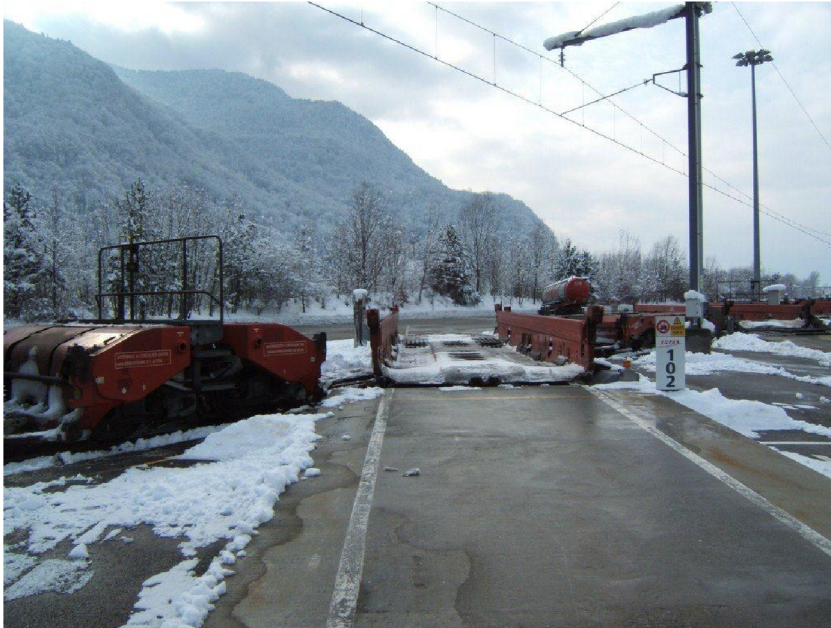
Obr. 4.25 Nakládka osobních automobilů na průvoz tunelem systémem Modalohr
