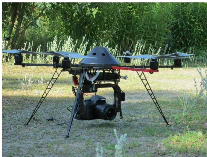
Obr. 1 Bezpilotní letoun Hexakopter XL se snímacím zařízením (autor: D. Cigánek, 2013)
