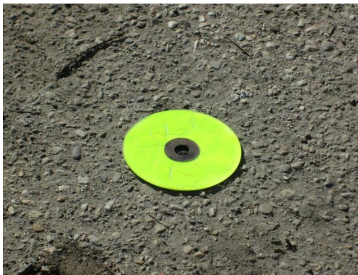
Obr. 11 Vlícovací bod umístěný před měřením (autor: D. Cigánek, 2013)
