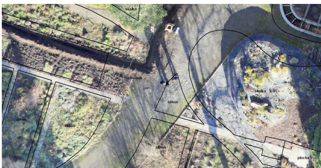
Obr. 13 Porovnání přesnosti původního podkladu s ortogonalizovanou fotomozaikou (autor: D. Hlaváč, 2014)
