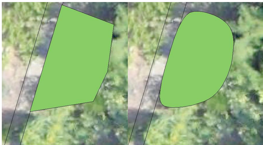
Obr. 10 Rozdíl mezi korunou dřeviny neshlazenou (vlevo) a korunou shlazenou (vpravo) (autor: D. Hlaváč, 2014)
