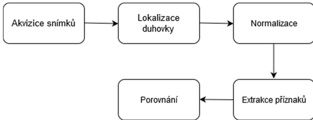
Obrázek 3: Blokové schéma biometrie duhovky
