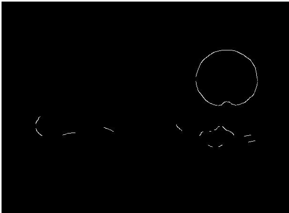
Obrázek 27: Detekce hrany zornice pomocí Cannyho detektoru
