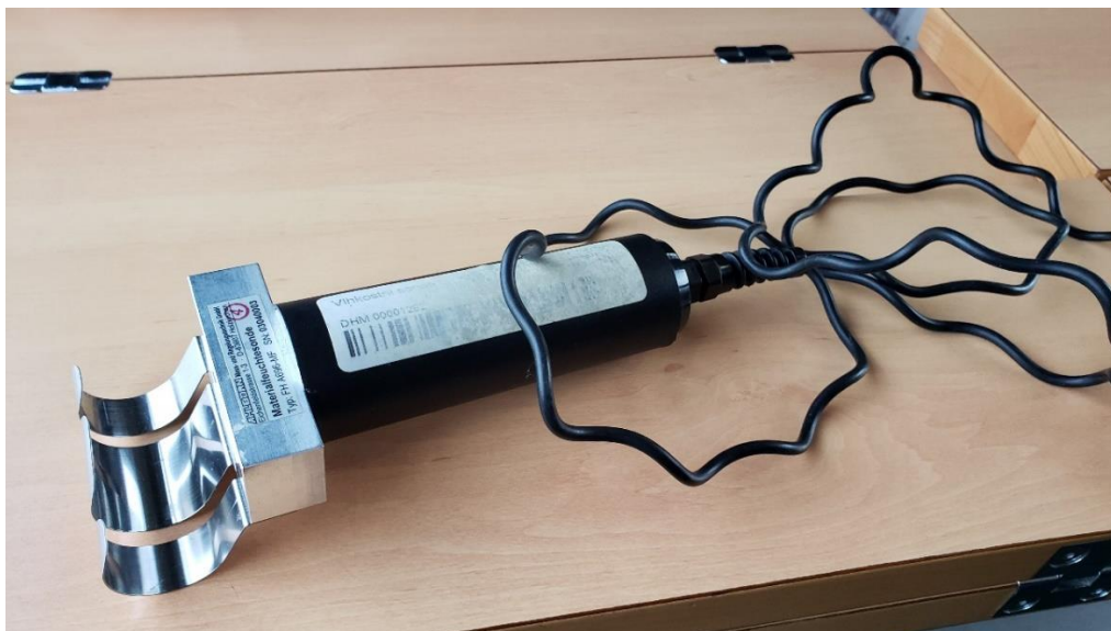
Obrázek 6: Čidlo použité pro měření relativní vlhkosti stěn
