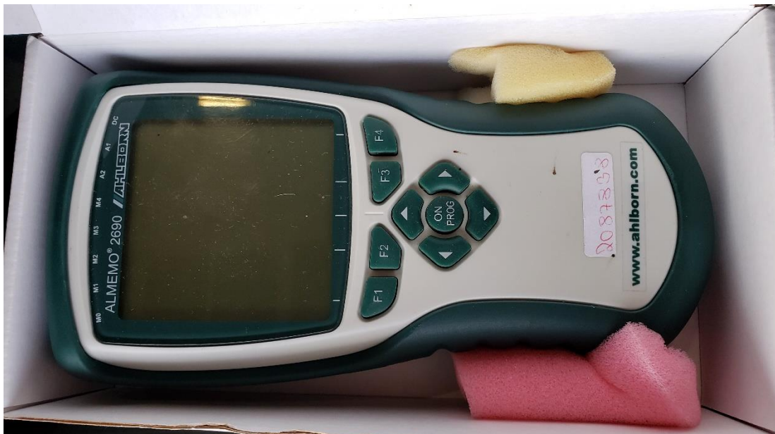
Obrázek 8: Kombinovaný univerzální ruční měřicí přístroj ALMEMO 2690
