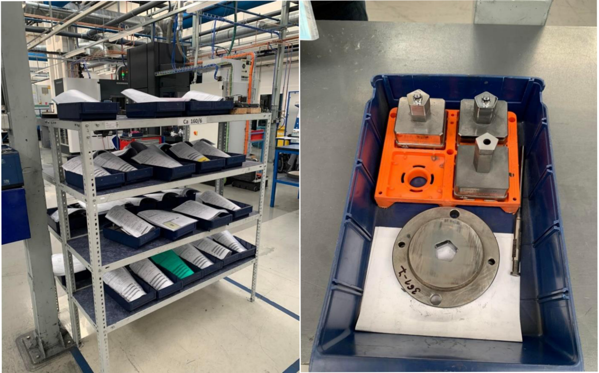
obr. 6 Předchystané lisovací nástroje, vlastní fotografie
