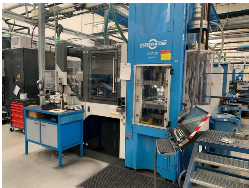
obr. 9 Lis Osterwalder CA320 na lisovně, zdroj vlastní foto
