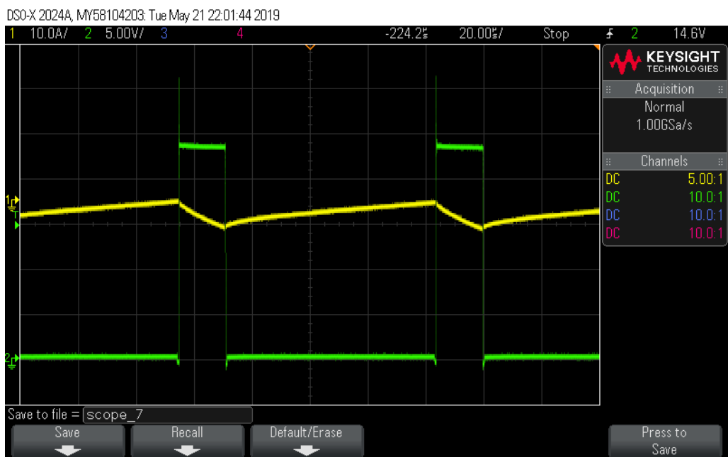
Obr. 5.9: CH1: Proud první fáze; CH2: Napětí na první fázi.
