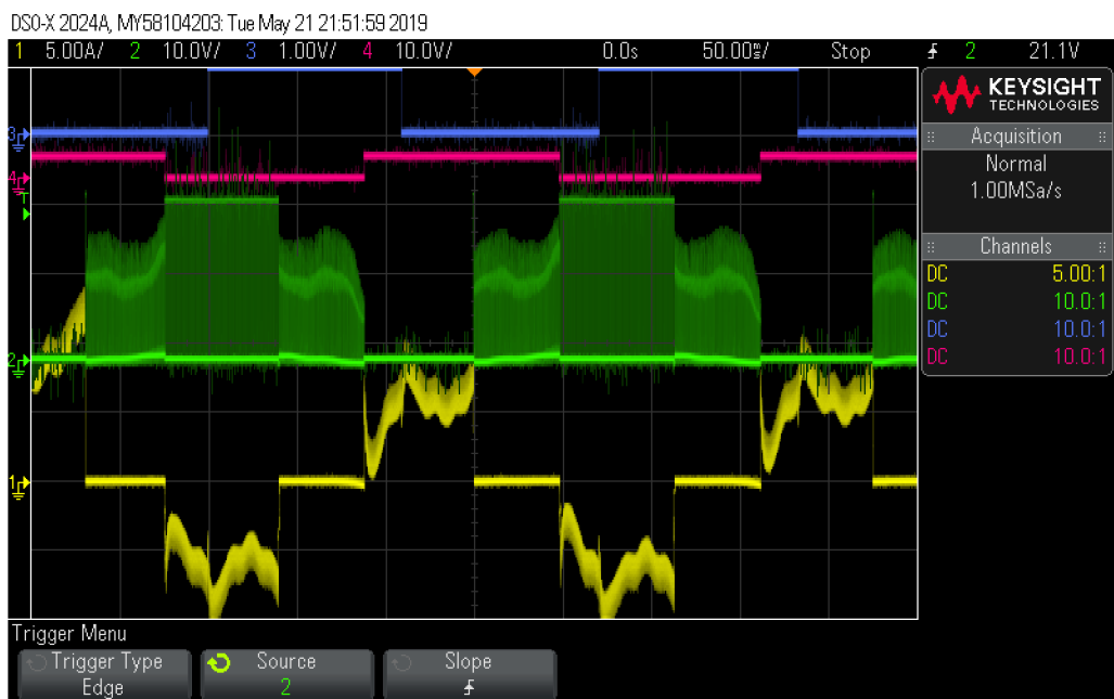
Obr. 5.4: CH1: Proud první fáze; CH2: Napětí na první fázi; CH3,CH4: Výstupy HALL sond.
