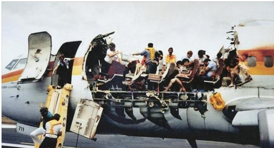
Obrázek 2.3 Trup Boeingu 737 letu Aloha Airlines 243 po nouzovém přistání [11]
