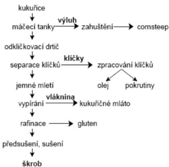
Obr. 4: Schéma výroby kukuřičného škrobu
