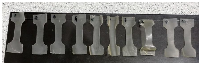
Obr. 17: Testovací tělesa pro tahovou zkoušku
