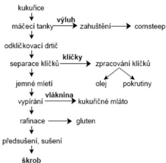
Obr. 4: Schéma výroby kukuřičného škrobu
