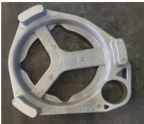
Obr. 28: Odlitek „Deska pohonu“
