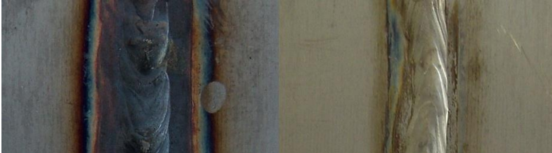
Obr. 3 - Porovnání kvality svaru po moření [23]
