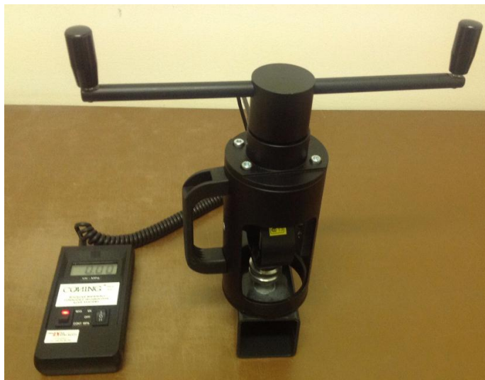
Obr. 66 - Odtrhová zkouška na FSI
