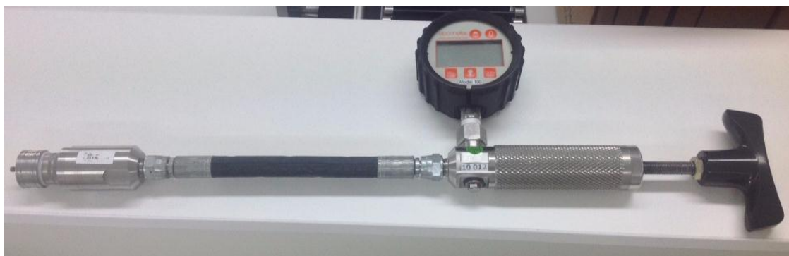
Obr. 62 - Hydraulický odtrhoměr Elcometer 108 [15]
