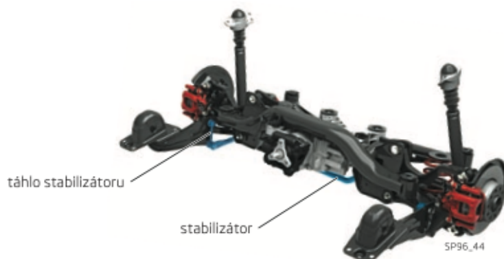
Obrázek 3 Zadní víceprvková náprava s pomocným rámem a Haldex spojkou pro pohon zadních kol, Octavia
