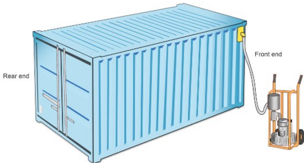
Obrázok 11 Ukážka dizajnu „predventilácie“ prepravných kontajnerov. Zdroj: (39)
