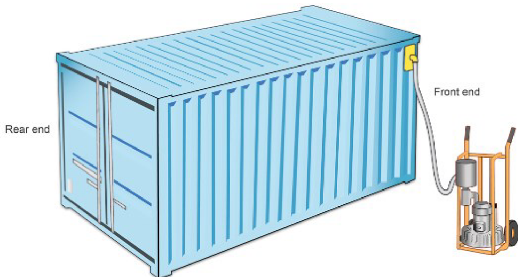
Obrázok 11 Ukážka dizajnu „predventilácie“ prepravných kontajnerov. Zdroj: (39)
