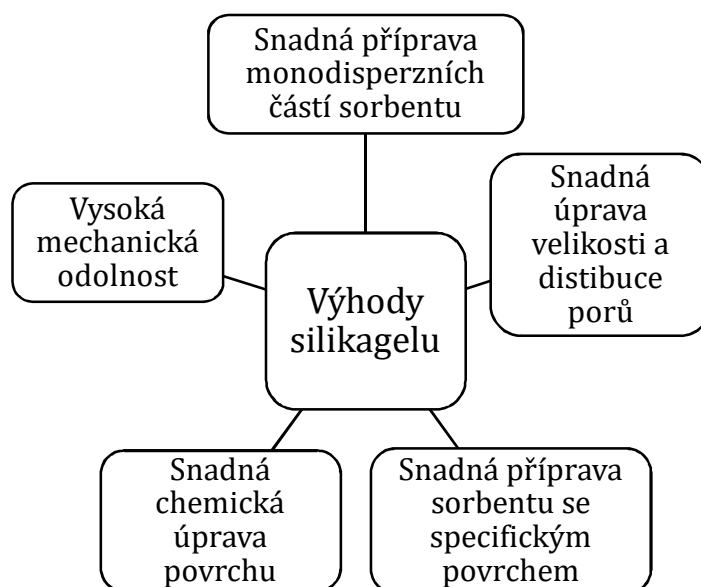
Obr. 8: Znázornění výhod použití silikagelu ve formě sorbentu [10].
