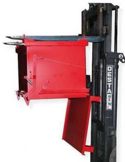
Obr. 3.5-13 Ukázka využití kontejneru s otevíracím dnem [18]
