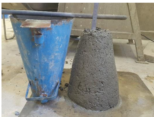
Obr. 15: Výsledek zkoušky sednutí kuželem
