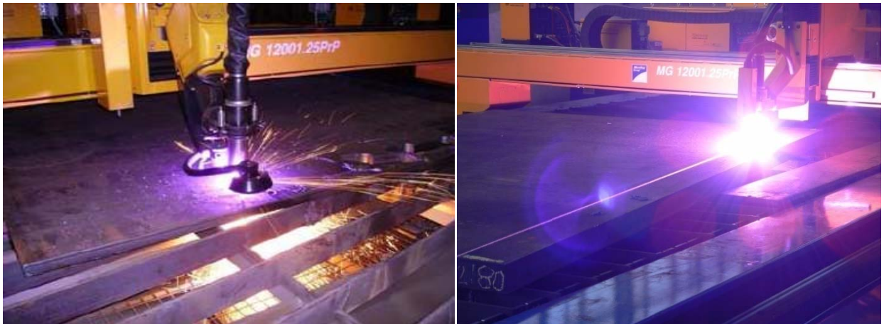
Obr. 7.4 CNC Tvarové pálení na plazmě Kjellberg Fine Focus
