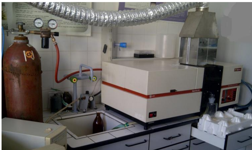
Obr. č 10 Atomový absorpční spektrometr s atomizací v plameni (SpectrAA 30)
