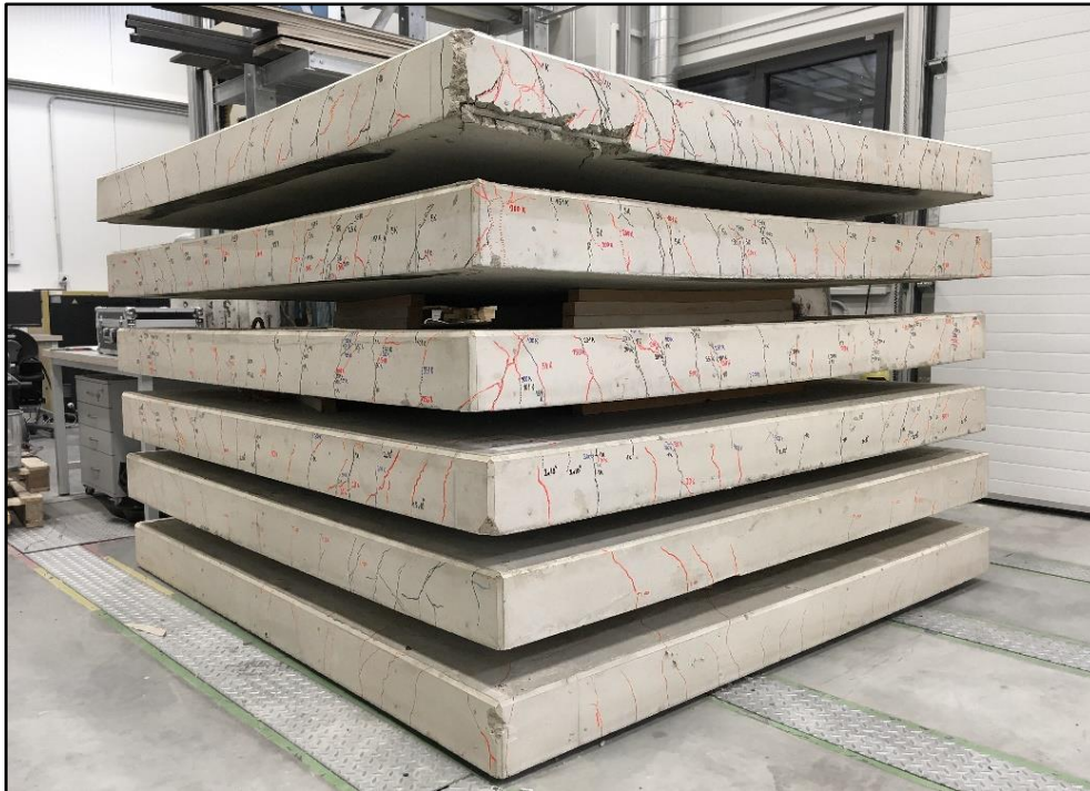
Obr. 121 Porušené vzorky zákrytových desek se zvýrazněnými trhlinami
