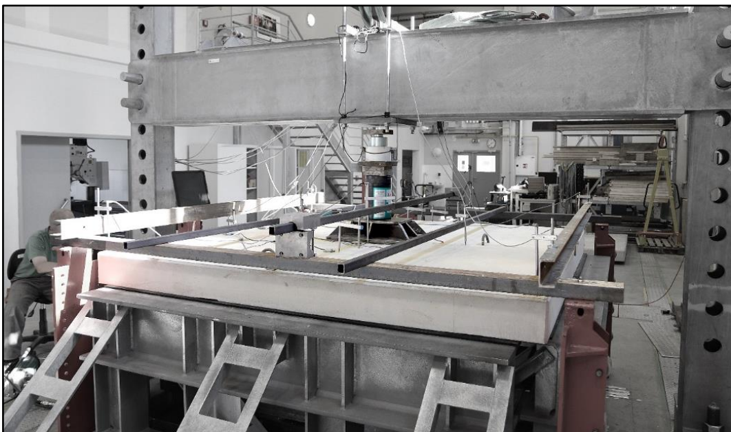
Obr. 81 Reálné provedení zkoušky vzorku z.GFRP.E.Ep.IV.N_5 s osazenou instrumentací
