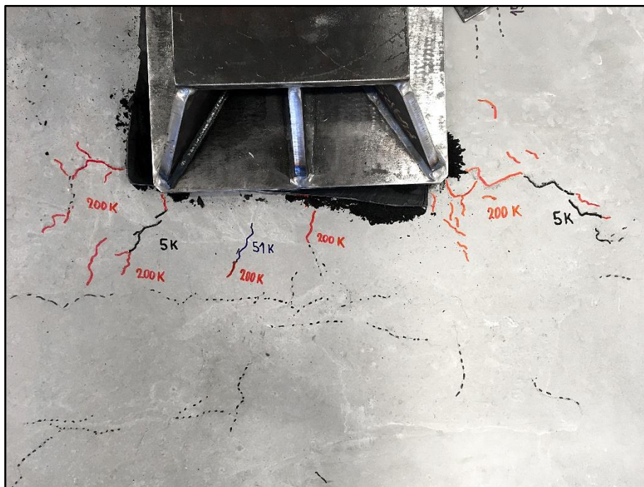
Obr. 107 Porušení horního povrchu desky a FRP výztuže po únavovém zatěžování desky z.GFRP.E.Ep.IV.N_1
