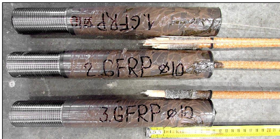
Obr. 35 Nežádoucí porušení prutu v koncovce v místě rozhraní tuhostí zálivky
