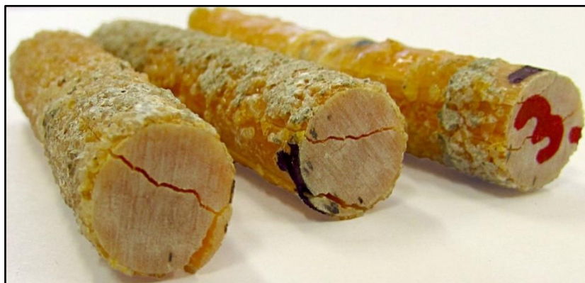
Obr. 37 Porušení vzorků GFRP.E.EP.II.N.10-E.1 podélnou trhlinou
