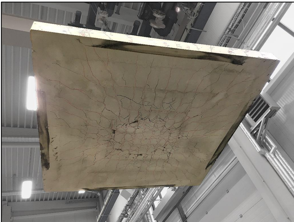
Obr. 103 Porušení spodního povrchu vzorku z.GFRP.E.Ep.IV.N_3 po monotónním zatěžování
