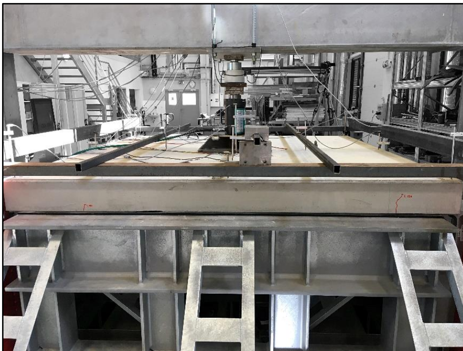
Obr. 85 Čelní strana vzorku z.ocel_1 po první fázi zatěžování se zvýrazněnými trhlinami
