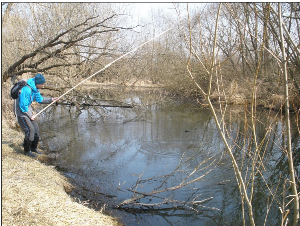
Obr. 59. Ukázka vlastního měření hloubky (zatěžující valoun se nachází v místě vyznačeném kruhem na vodní hladině)
