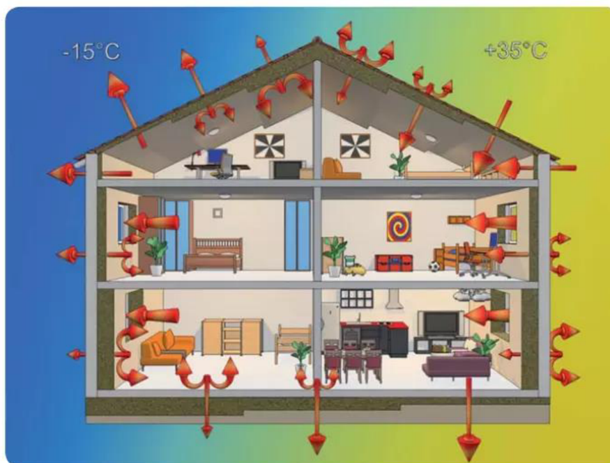
Obr. 1 – Schéma tepelných ztrát [2]
