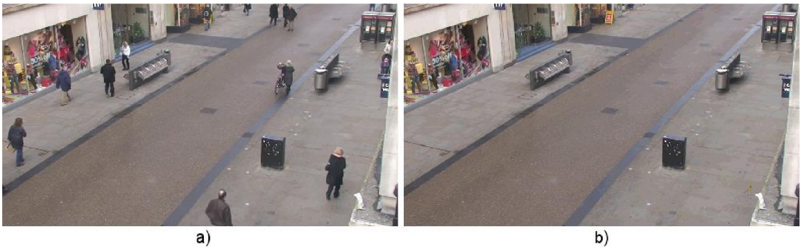
Obrázek 2.4: Pozadí scény zachycené stacionární kamerou. a) Snímek scény s hodně chodci. b) Pozadí scény po analýze scény po dobu několika vteřin. (převzato z [18])
