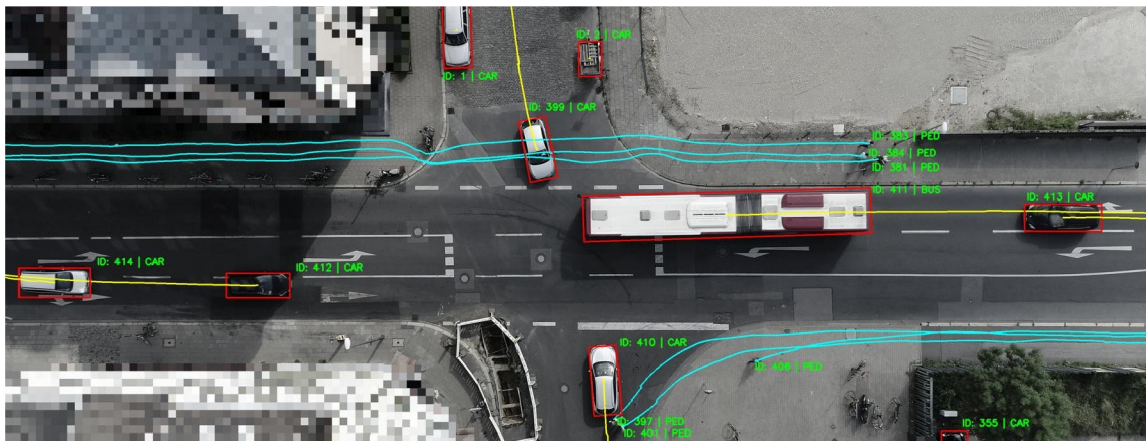
Obrázek 2.5: Znáznornění typů a trajektorií monitorovaných objektů na vozovce (převzato z [2]).
