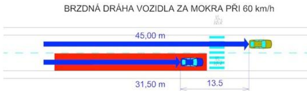
Obr. 37: Rocbinda a vliv na brzdou dráhu za mokra [23]
