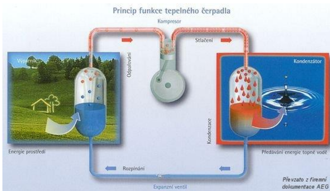
Obr. 12 Princip tepelného čerpadla [11]
