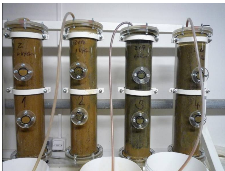
Obr. 9: Aparatura kombinovaných kolonových zkoušek
