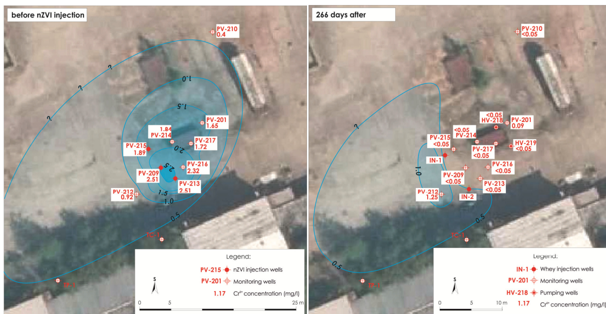
Obr. 28: Koncentrace Cr(VI) v podzemní vodě před aplikací nZVI a 266 dní po aplikaci substrátu
