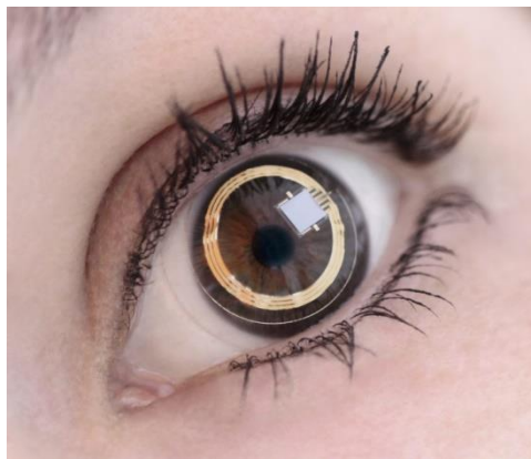
Obr. 5 – Triggersfish od společnosti SENSIMED, kontaktní čočka s odporovými tenzometry, telemetrickým mikroprocesorem a anténou [30]
