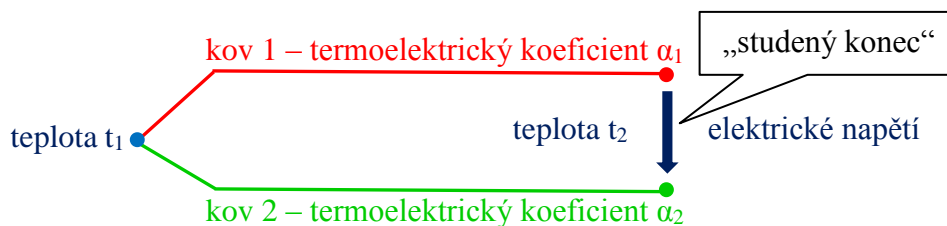
Obr. 17 Princip funkce termočlánku
