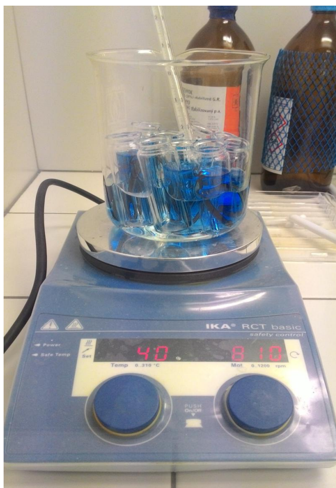
Obr. 14: Zkumavky s Mutvei roztokem a jednotlivými řezy na magnetickém míchadle s ohřevem (Holečková, 2017)
