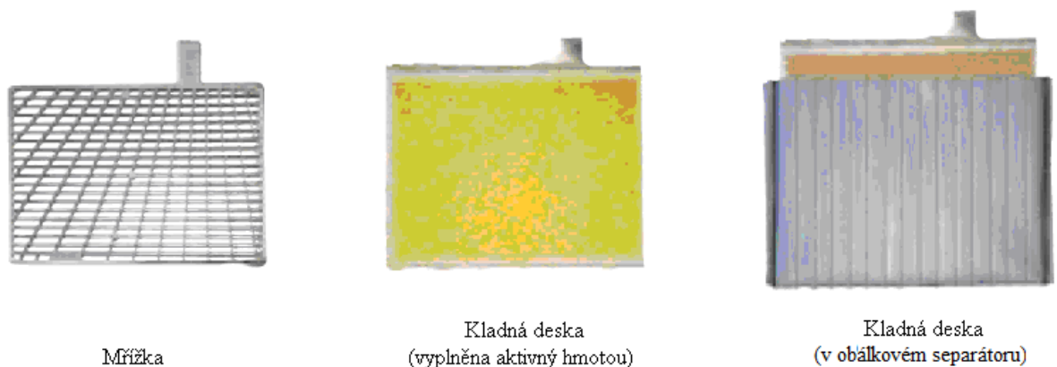
Obr.2 a. Mřížka, b. Kladná deska (vyplněna aktivní hmotou), c. Kladná deska (v obálovém separátoru)
