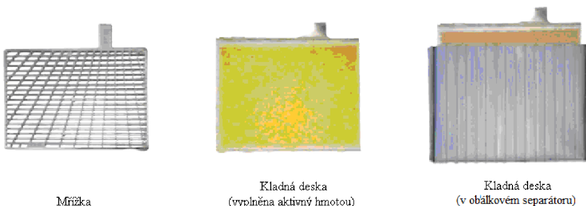
Obr.2 a. Mřížka, b. Kladná deska (vyplněna aktivní hmotou), c. Kladná deska (v obálkovém separátoru)
