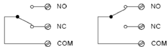
Obr. 12: Funkce přepínačů na reléové kartě
