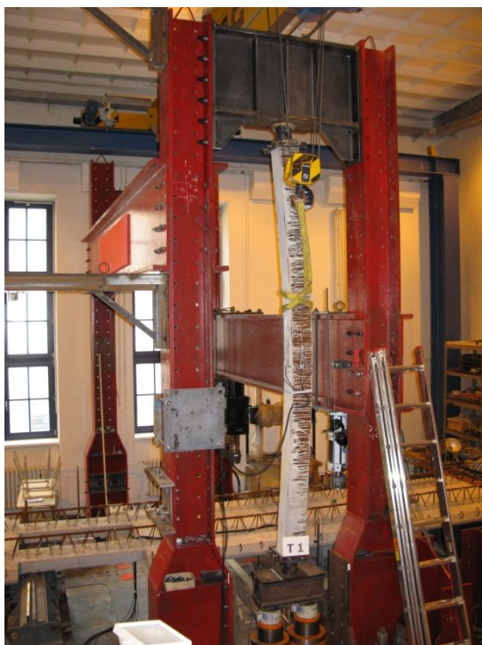
Obr. E.19 Porušení zkušebního tělesa H160-4
