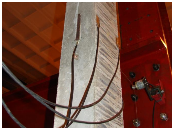
Obr. E.10 Umístění tenzometrů LY 11 10/350 a LY 41 100/120
