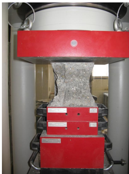
Obr. E.14 Krychle po porušení při tlakové zkoušce betonu
