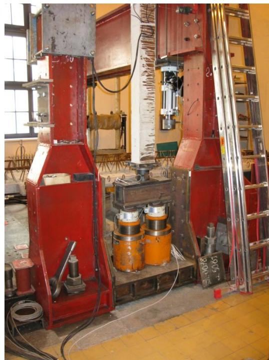
Obr. E.2 Příprava na zatěžování sloupů pilotního experimentu
