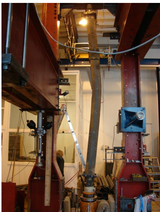
Obr. E.45 Porušení zkušebního tělesa H14
