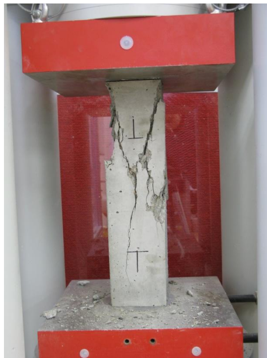
Obr. E.12 Tlakové porušení trámce na závěr zkoušky
