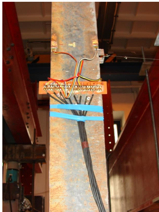
Obr. E.40 Umístění tištěného spoje pro snímání dat z tenzometrických snímačů
