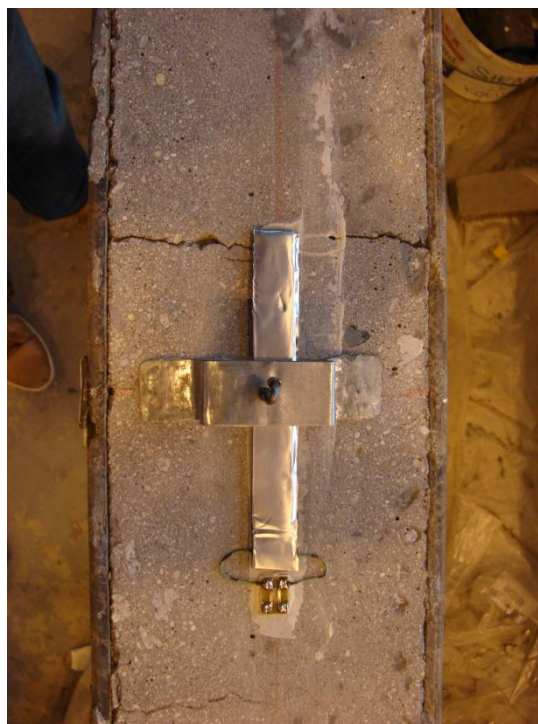
Obr. E.44 Výsušné trhliny zkušebního tělesa H14
