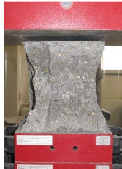
Obr. 1.2 Typické porušení betonového vzorku při tlakové zkoušce
