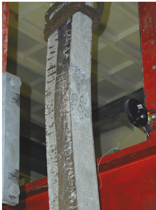
Obr. E.18 Tlakové porušení betonu na konvexní straně uprostřed rozpětí prutu
