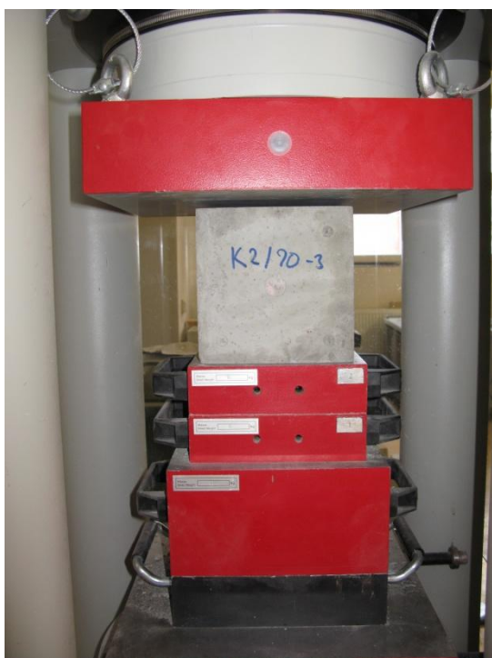
Obr. E.13 Zkušební krychle pro určení pevnosti betonu v tlaku
