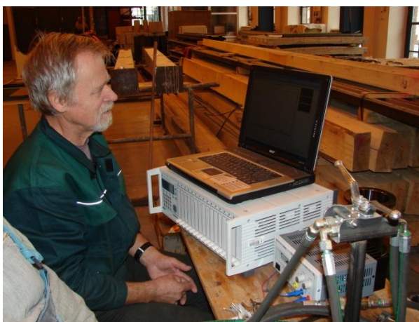
Obr. E.34 Měřicí ústředna MGCplus a stolní počítač s měřícím softwarem CATMAN easy
