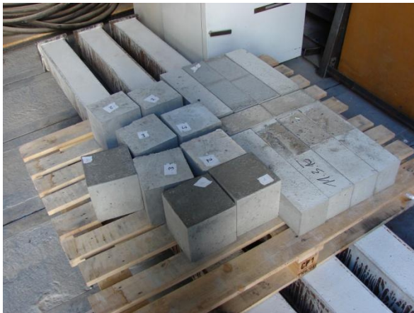
Obr. E.5 Zkušební vzorky pro určení materiálových charakteristik betonu
