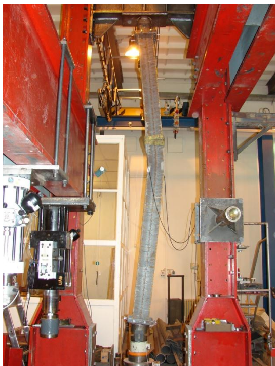
Obr. E.35 Porušení zkušebního tělesa H5
