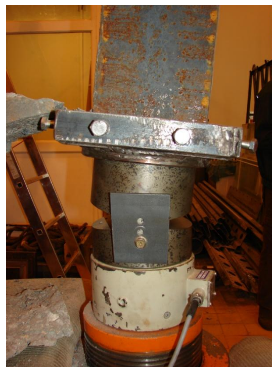
Obr. E.46 Natočení uložení prutu po dokončení zatěžování
