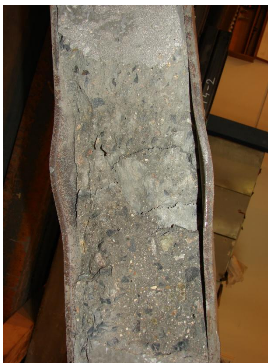
Obr. E.38 Plastizace ocelového profilu na tlačené straně průřezu, která vznikla až po dosažení maximální vzpěrné pevnosti po odstřelení části betonu
