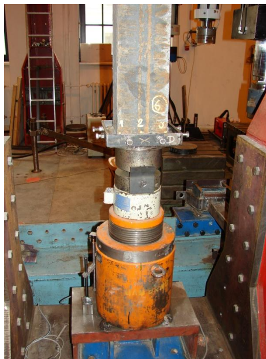
Obr. E.32 Uložení zkušebního tělesa H6
