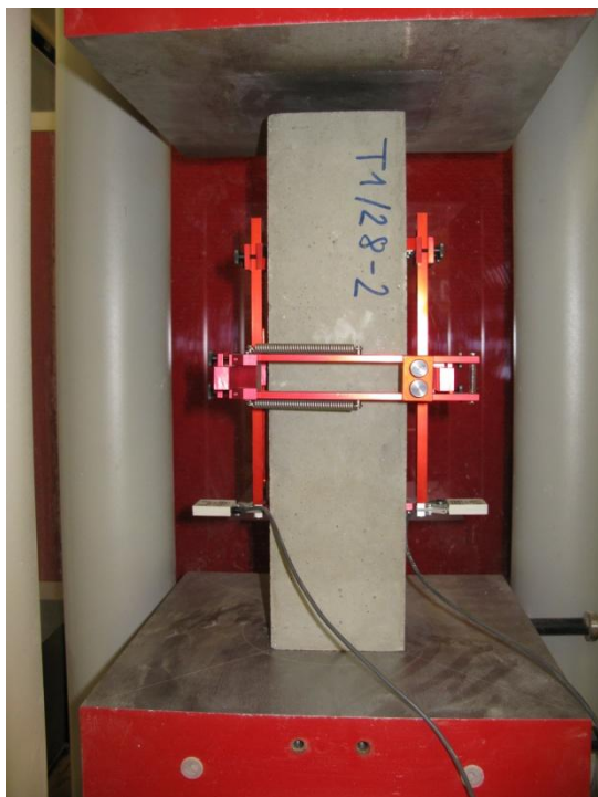
Obr. E.11 Umístění snímacího zařízení pro určení statického modulu pružnosti betonu
