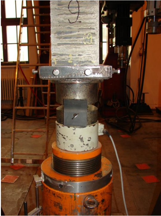
Obr. E.23 Uložení zkušebního tělesa H9
