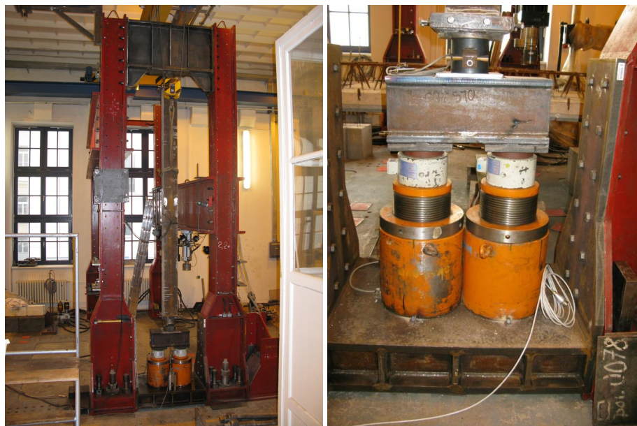
Obr. 6.4 Zatěžovací stolice, dvojice hydraulických lisů o max. zatěžovací síle 4000 kN
