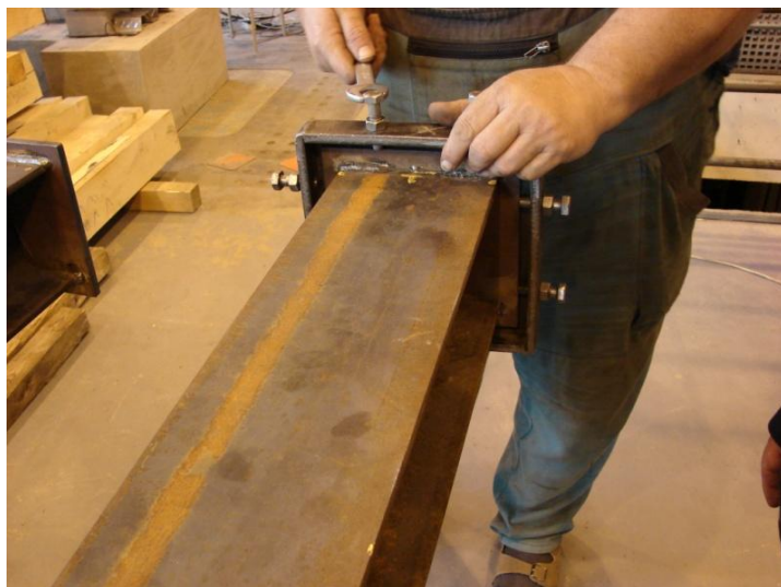
Obr. 6.2 Centrování zkušebního tělesa
