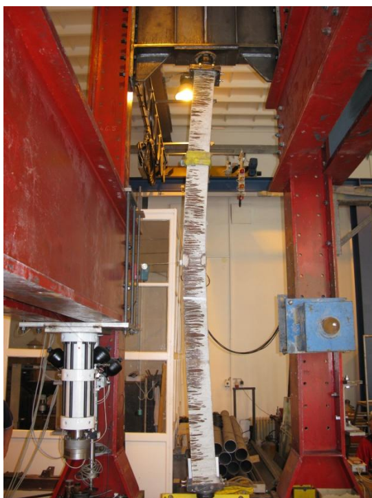
Obr. E.21 Porušení zkušebního tělesa H160 - 5
