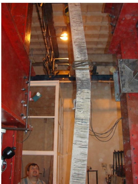
Obr. E.29 Porušení zkušebního tělesa H7
