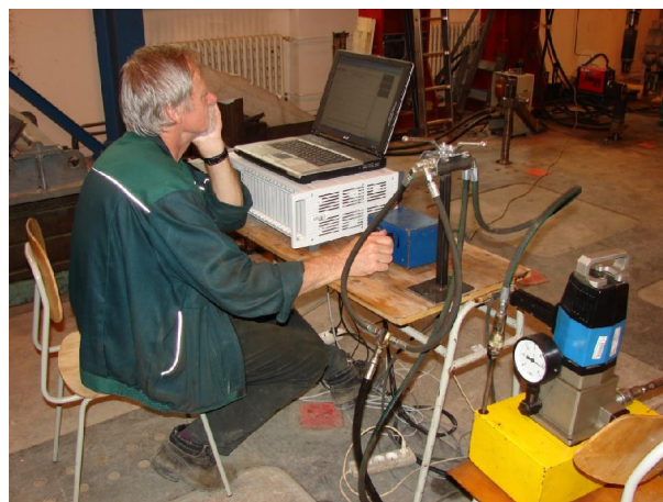
Obr. E.4 Měřicí ústředna a regulace tlaku v hydraulických válcích
