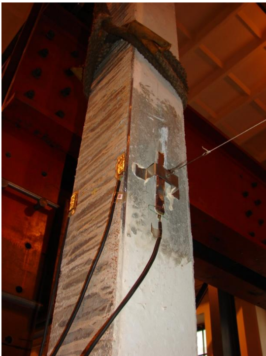
Obr. E.25 Ukotvení lanka potenciometrického snímače posunutí
