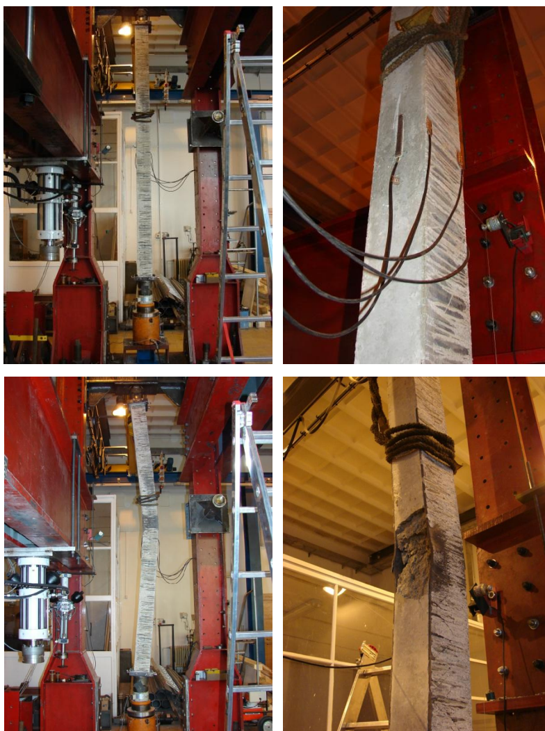
Obr. 6.12 Zkušební tělesa H4, H5, H6 při vybočení
