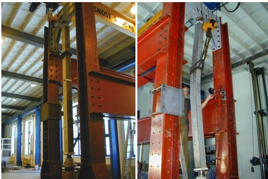
Obr. 6.9 Zkušební tělesa T16, T17, T18 při vybočení
