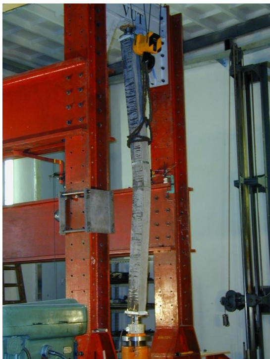
Obr. E.15 Porušení zkušebního tělesa T16
