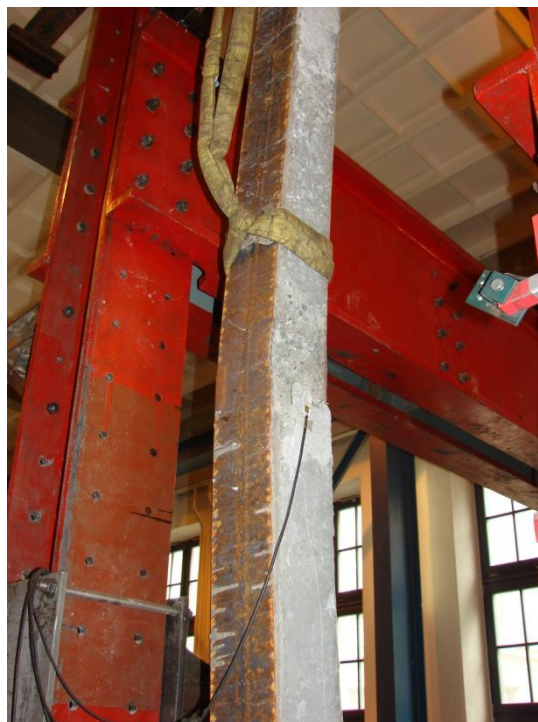
Obr. E.36 Tlakové porušení betonové části průřezu
