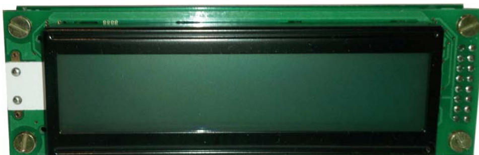
Obrázek B.2 Displej s rozlišením 192x32 bodů
