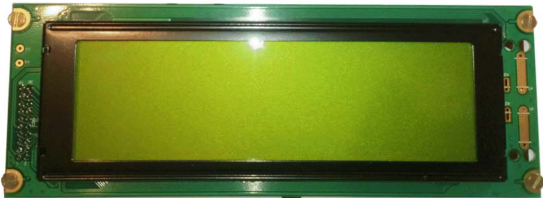
Obrázek B.6 Displej s rozlišením 240x64 bodů
