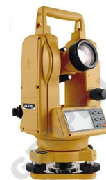
Obrázek 14: Teodolit GPI GT-116 [13]
