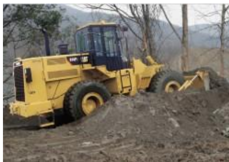
Obrázek 45: Dozer CATERPILLAR 814F [6]
