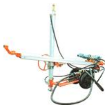
Obrázek 65: Vrtací sloup VS – 1 [11]
