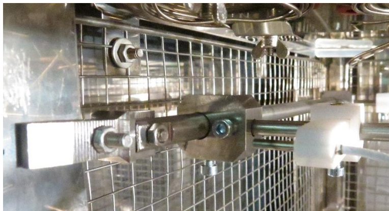
Obr. 6-2 Uchycení teplotního snímače a konstrukce v komoře
