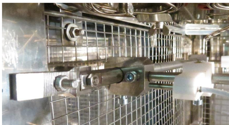
Obr. 6-2 Uchycení teplotního snímače a konstrukce v komoře
