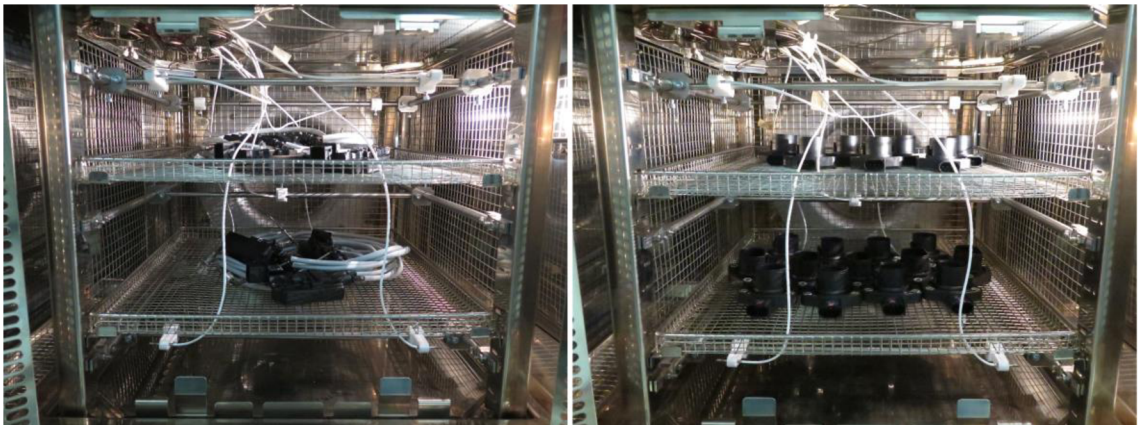
Obr. 6-4 Standardní zátěže použité při konfirmaci teplotní šokové komory
