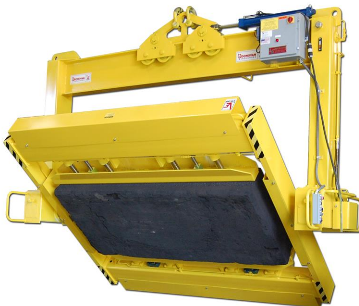
Obr. 12) Upínání formy pomocí upínacího rámu [12]
