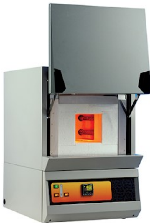
Obr. 7.25: Pec pro zkoumání vlastností mřížek pod vlivem vysokých teplot [24]
