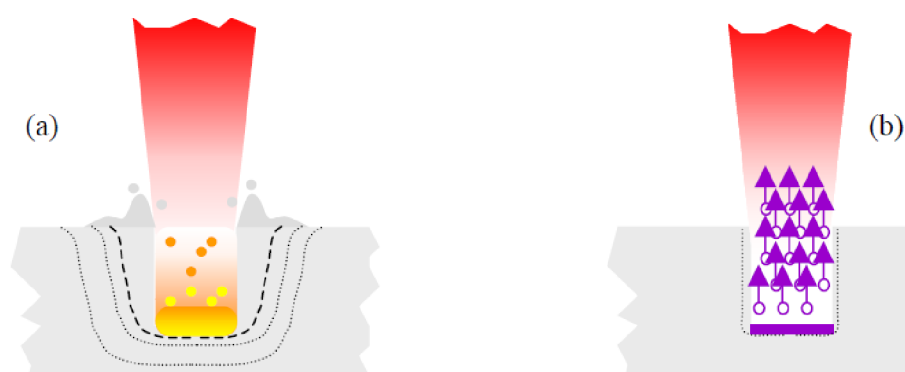
Obr. 5.1: Schéma ukazující rozdíl mezi (a) konvenčním mikroobráběním a (b) obráběním femtosekundovým laserem [13]
