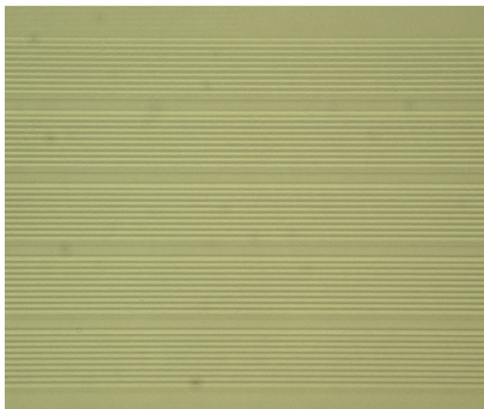
Obr. 7.4: Braggova mřížka zapsaná do planárního vzorku
