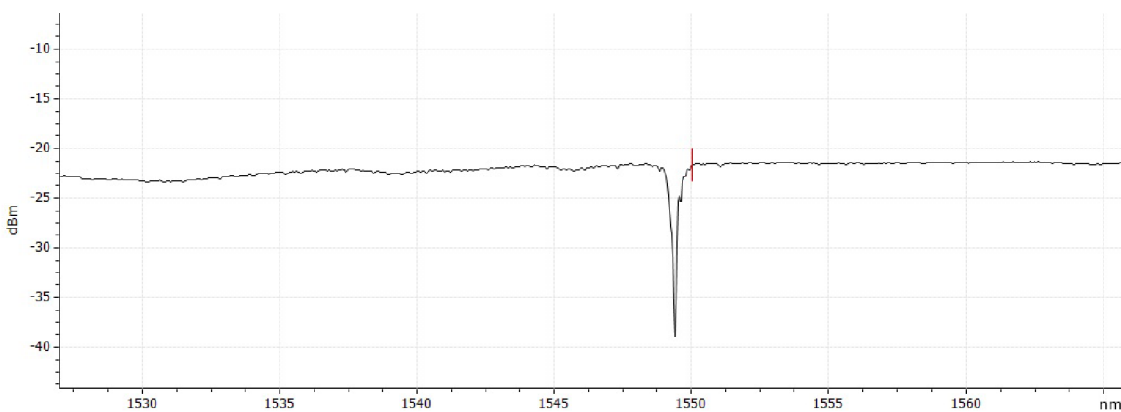
Obr. 7.11: Spektrum v průchodu zapsané Braggovy mřížky
