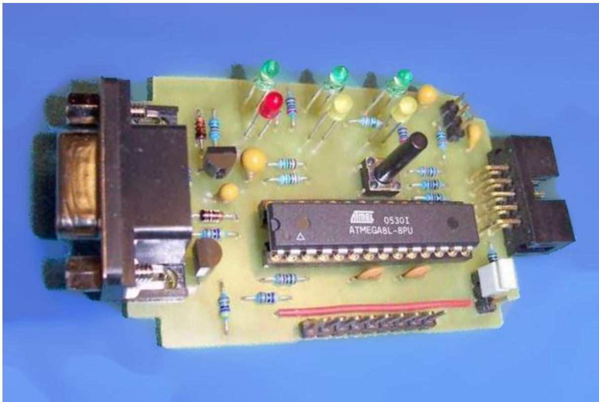
Obr. 21: Fotografie programátoru BiProg (převzato z [8])
