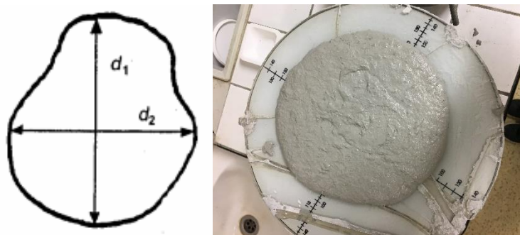
Obr. 23: Schéma měření rozlivu (vlevo); rozlití kužele (vpravo)
