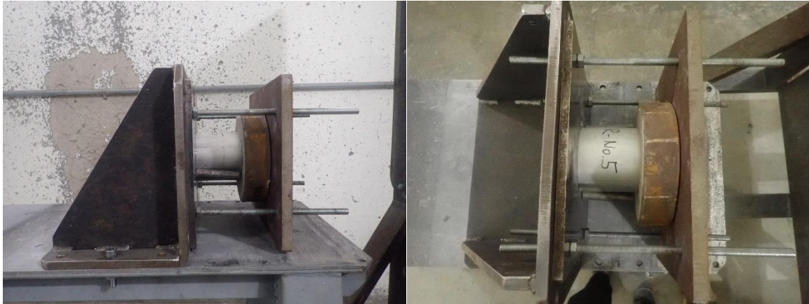
Obr. 27: Umístění vzorku a svědečného materiálu ve zkušebním rámu
