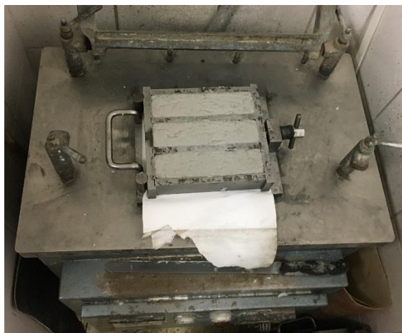
Obr. 22: Připravené vzorky na vibračním stole
